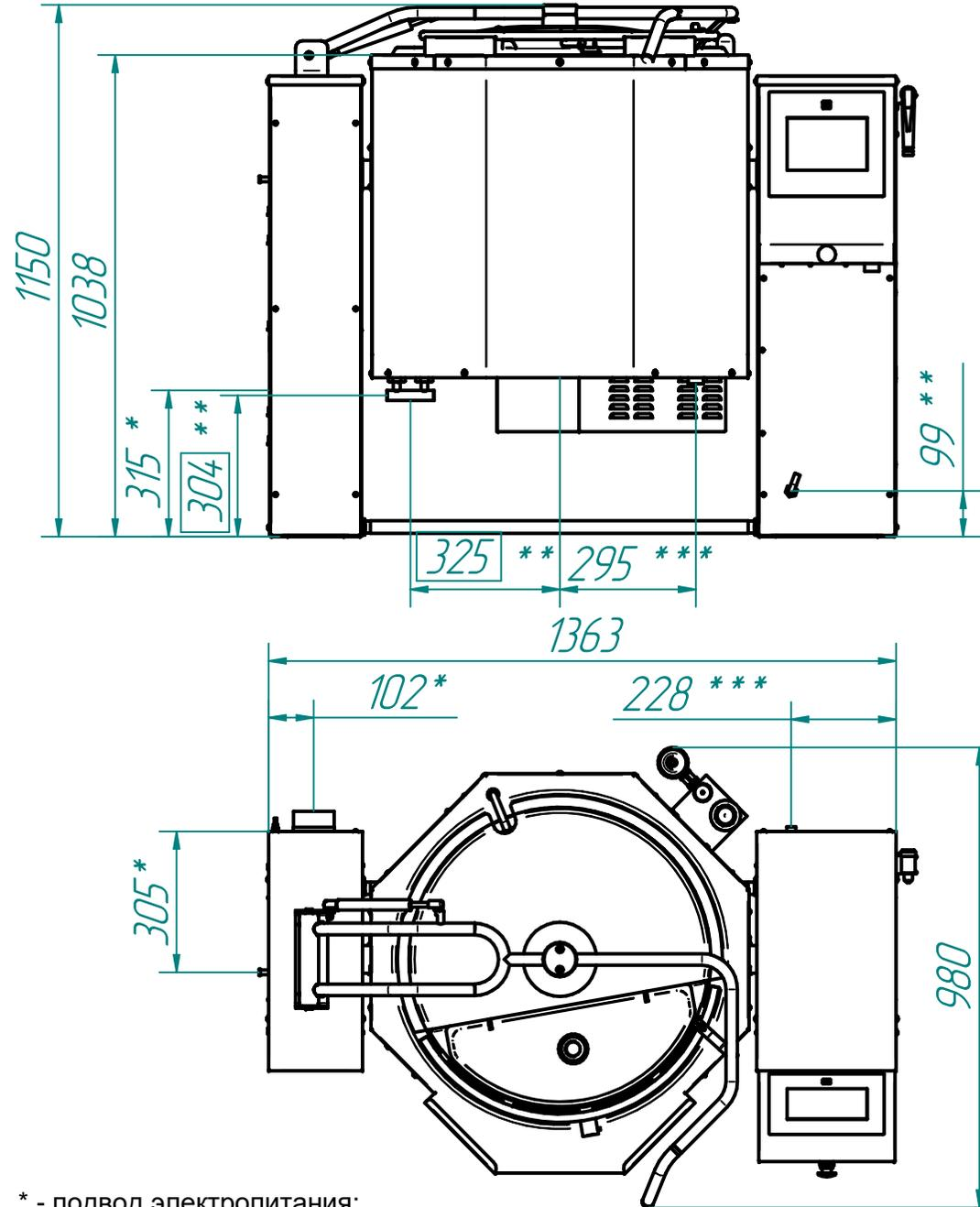
Котлы пищеварочные электрические с функциями опрокидывания, перемешивания и охлаждения типа КПЭМ предназначены для приготовления бульонов, соусов, десертов, супов и различных вторых и третьих блюд. Котлы используются на предприятиях общественного питания, столовых производственных предприятий и на производствах различных продуктов питания, как самостоятельно так и в составе технологических линий.
