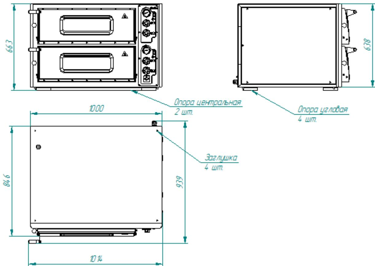
Рис.2 Общий вид печи ПЭП-4x2
