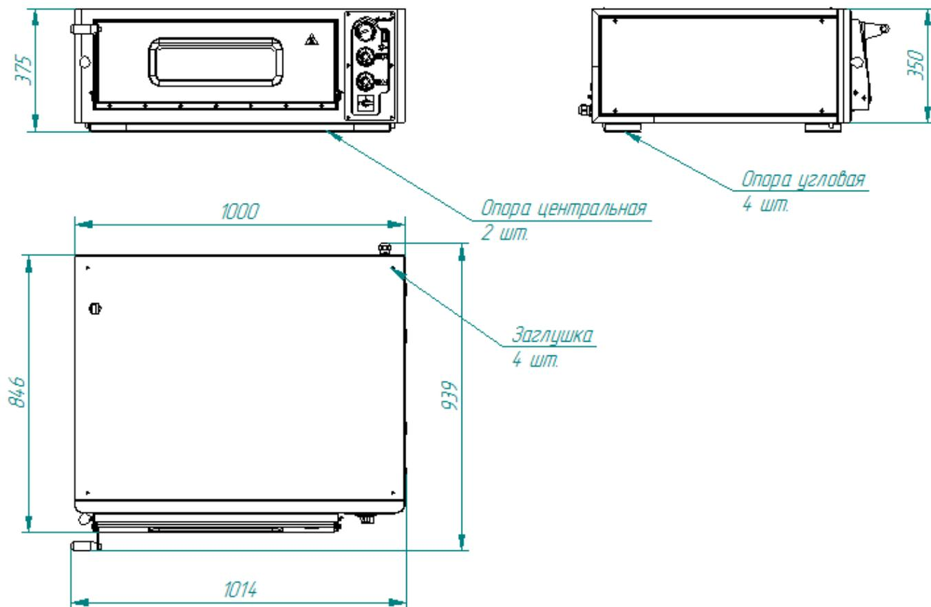
Рис.1 Общий вид печи ПЭП-4
